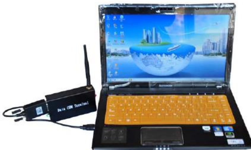
Рисунок 3.1.4 Соединение коммуникационного терминала с персональным компьютером.
