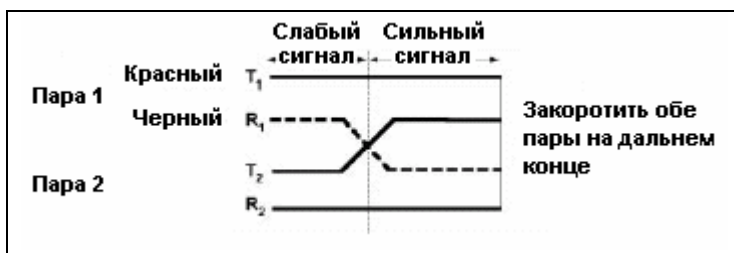
Рисунок 4. Подключите зажим красного цвета к жиле А пары 1, зажим черного цвета к жиле Б пары 1.
