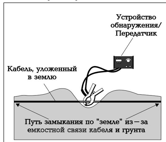
Рис.13. Размещение устройства индуктивной связи в средней части прогона.
