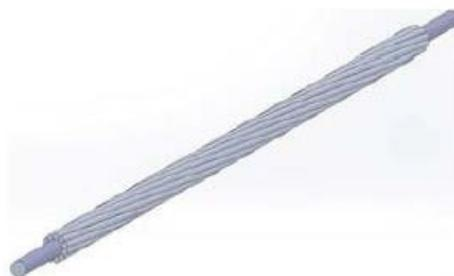
3. Прикрепите нижнюю полусферу к проводу. Привяжите изолирующие полоски с обеих сторон линии электропередачи, чтобы проводник с армирующими стержнями можно было закрепить в прорезях зажимов с обеих сторон. Убедитесь, что оставшаяся часть армирующих стержней выступает из зажимов с обеих сторон на равное расстояние.
