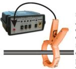
При подключении генератора при помощи клещей-индуктора (К-100) достигается более высокий уровень сигнала пинии значительно снижается впияние на соседние Клещи представляют магистрали. собой индукционную катушку разъемным магнитопроводом, который замыкается вокруг искомогог кабеля.
