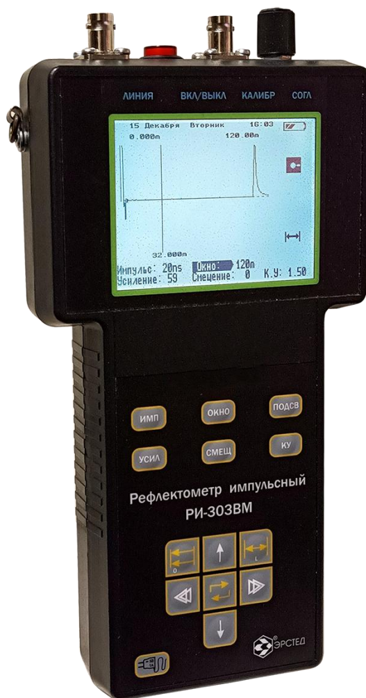
Рисунок 4-1. Внешний вид прибора РИ-303ВМ
