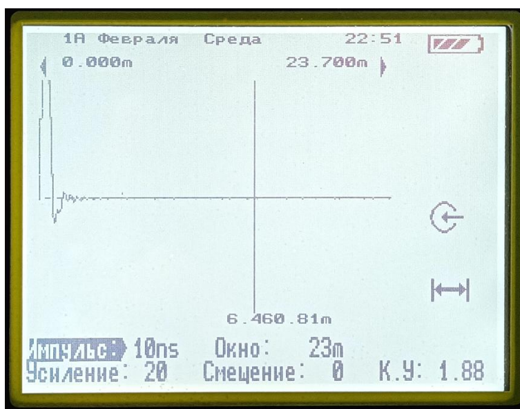
Рисунок 6-1 Вид дисплея в режиме ИЗМЕРЕНИЕ
