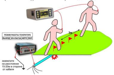
Для уточнения результатов измерители располагаются (трубопроводу). перпендикулярно кабелю Один измеритель с приемником и датчиком в руке располагается непосредственно над кабелем (трубопроводом), второй на расстоянии провода (примерно 3м) с датчиком в руке в стороне от кабеля (трубопровода). Двигаясь вдоль кабеля (трубопровода), наблюдайте за уровнем сигнала. При прохождении повреждения уровень сигнала возрастает, далее падает. Место повреждения соответствует максимальному сигналу.
