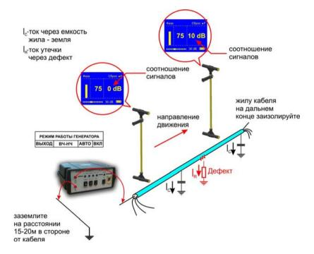
Режим «*НЧ-ВЧ*» использует двухчастотный метод, в котором генератор в режиме «**НЧ-ВЧ**» посылает в линию сигналы сразу на двух частотах. Поскольку глубина залегания и условия прохождения трассы влияет на сигналы одинаково, их соотношение остается постоянным. Оно не зависит от положения измерителя и сохраняется при движении вдоль трассы.
