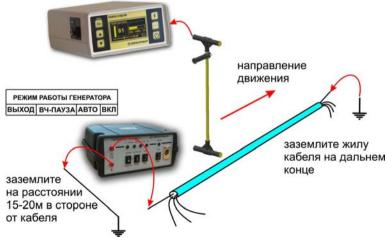
При поиске трубопроводов либо защитных тросов генератор подключается одним проводом к трубопроводу (тросу), другим - к штырю заземления. Штырь заземления относится на расстояние не менее 15 - 20 м в сторону от трубопровода (троса). Поскольку
