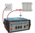
способ 2: вывод генератора подключить к жиле скрытой проводки, второй вывод к шине заземления (заземление в розетке, батареи центрального отопления, водопроводной трубе).
