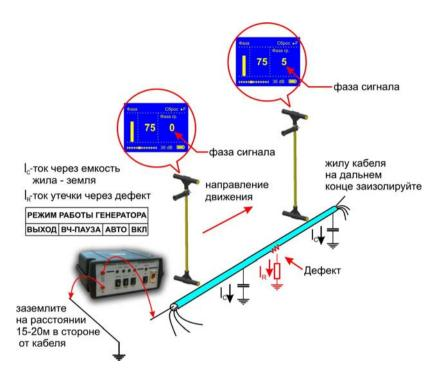
Режим « $\Phi A3A$ » использует двухчастотный фазовый метод. Генератор в режиме «B4» посылает в линию сигнал сразу на двух частотах. После прохождения повреждения фаза сигнала изменяется.
