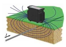
Установите генератор на земле перпендикулярно кабелю или трубе. Включите режим «ИНДУКТОР» «ВЧ-И **ПАУЗА**», при этом встроенный индуктор излучает переменное магнитное поле, которое порождает ток в коммуникации (показано на рисунке). Поле, возбуждаемое током контролируется трассоискателем.
