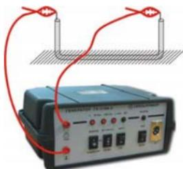
**способ 1:** вывод генератора подключить к жиле скрытой проводки, второй вывод к этой же жиле на дальнем конце проводки (например, провод теплых полов)
